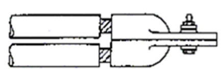
圖一五～十一 絞線之終端連接法
